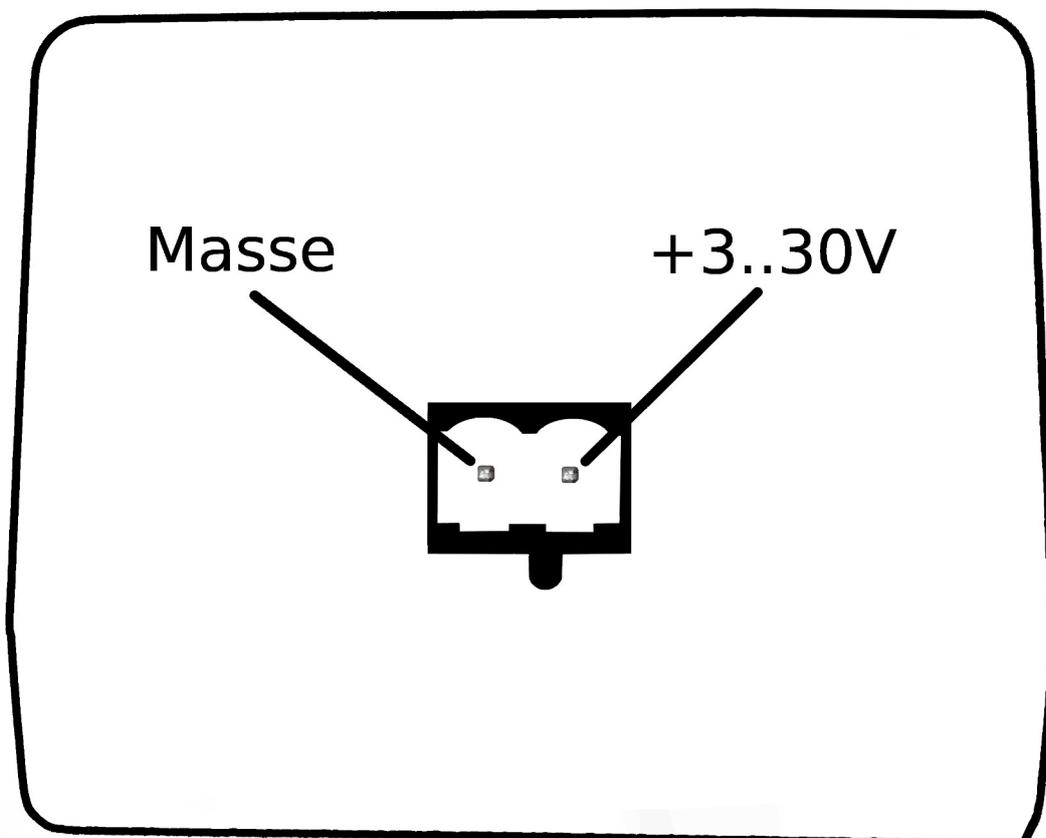
Bei Verwendung des optional erhältlichen „Anschlusskabels Laborstecker“:
