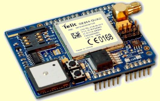
*Arduino*-Boards können durch das Aufstecken sogenannter "Shields" um wertvolle Funktionen erweitert werden. Mit dem **GSM/GPRS/GPS-Shield** wird das *Arduino*-Board um GSM- (Mobilfunk) und GPS-Funktionalität (Navigation) erweitert um damit beispielsweise
