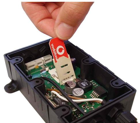
Die SIM-Karte wird gemäß Abb. in den beweglichen Teil des SIM-Kartenhalter eingeschoben (Kontaktflächen nach unten). Danach wird dieser Teil herunter geklappt und eingerastet.
