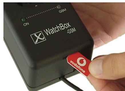
**ACHTUNG:** Vor dem Einschieben/Herausziehen der SIM-Karte muss die **AlarmBox-GSM** stromlos gemacht werden (d. h. aus der Steckdose gezogen werden!). Der Inhalt der gesamten SIM-Karte, also nicht nur der Inhalt des Telefonbuches, könnte ansonsten zerstört werden, was dann einen kostenpflichtigen Austausch durch den Provider nach sich zieht.
